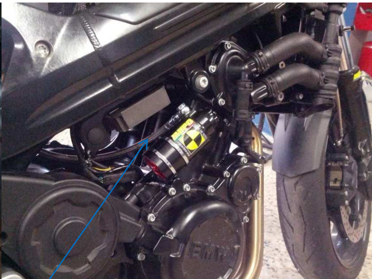
Tubo remoto serbatoio A
